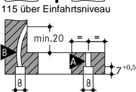
**A** Kunststoff- oder Stahl-Panzerrohr M20
